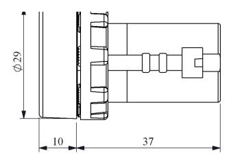
Montaj Ölçüsü Ø22.4  $\pm 0.2 \text{ mm}$
