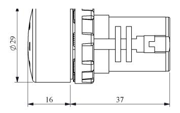
Montaj Ölçüsü Ø22.4  $\pm 0.2 \text{ mm}$
